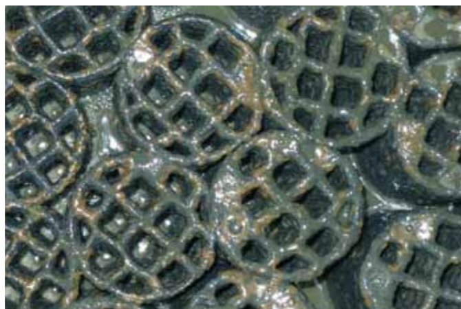
Support de bactéries en nid d'abeilles dans l'HYFAD®
